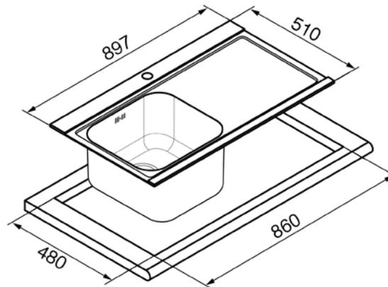
• **Inox brossé** • 1 cuve 40 x 34 cm • Profondeur cuve 21 cm • **2 planches coulissantes en verre et inox** • Epaisseur frontale de 4 mm • Côtés affleurants pour coulissement planches en verre • Bondes Ø 90 • Prépercé pour montage robinet • Sous-évier minimum 90 cm • Trop-plein anti-débordement • Livré avec bonde et siphon plat avec branchement lave-vaisselle
