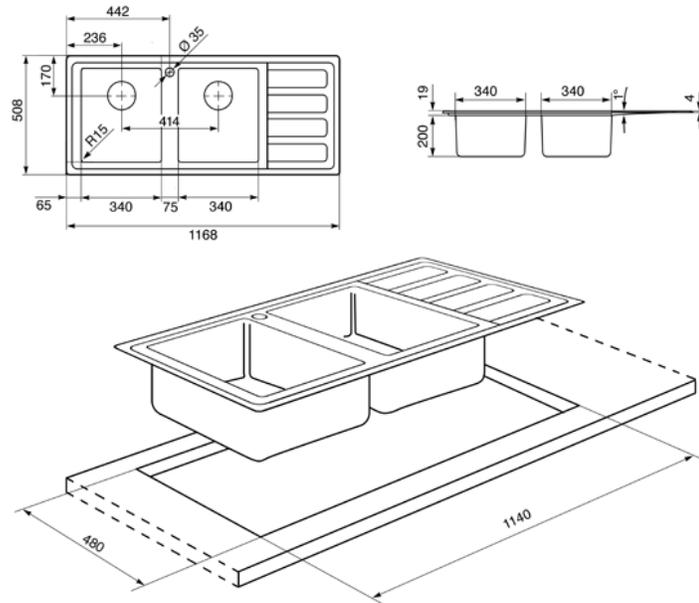
• **Inox brossé d'épaisseur 1 mm** • Bord 4 mm • 2 cuves de 34 x 40 cm • **Cuves à rayons minimum 15 mm** • Profondeur cuve 20 cm • Bonde Ø 90 • Prépercé pour montage robinet • Trop-plein anti-débordement • Livré avec bondes et siphon plat avec branchement lave-vaisselle
