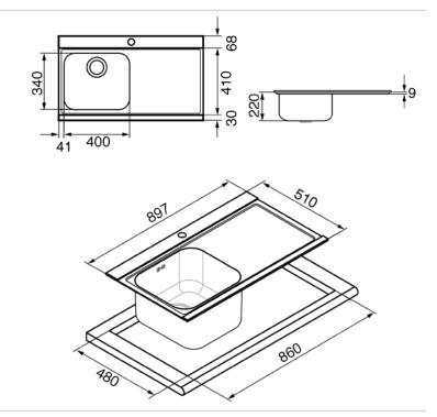
• Inox brossé • 1 cuve 40 x 34 cm • Profondeur cuve 21 cm • 2 planches coulissantes en verre et inox • Epaisseur frontale de 4 mm • Côtés affleurants pour coulissement planches en verre • Bondes Ø 90 • Prépercé pour montage robinet • Tropplein anti-débordement • Livré avec bonde et siphon plat avec branchement lave-vaisselle
