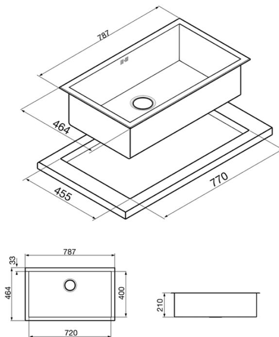
• Inox brossé d'épaisseur 1 mm • Bord 3 mm • 1 cuve géante 72 cm • Profondeur cuve 21 cm • Bonde Ø 90 • Trop-plein anti-débordement • Livré avec bonde et siphon plat avec branchement lave-vaisselle
